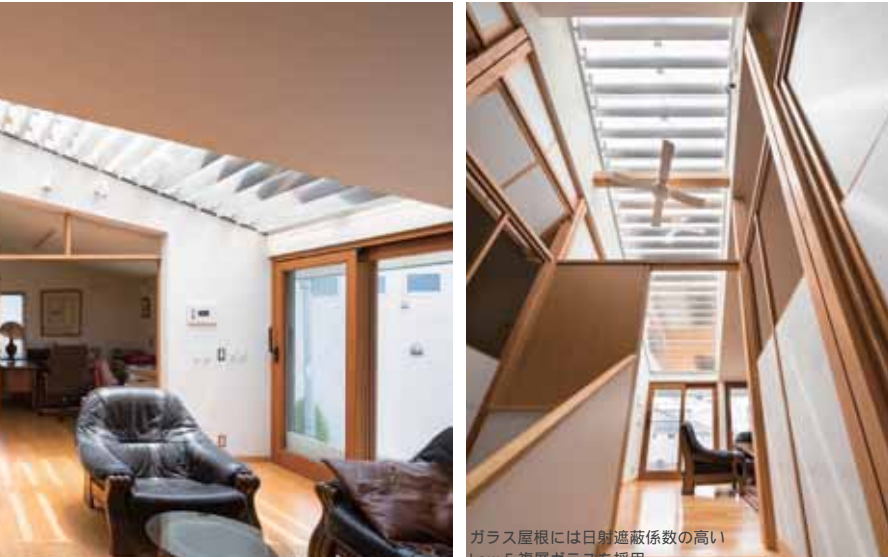
ガラス屋根には日射遮蔽係数の高いLow-E複層ガラスを採用
