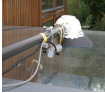
ガラス面屋根上の長波放射計
